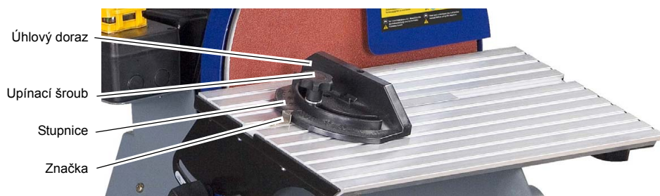
Obr.4-2: Nastavení úhlového dorazu
