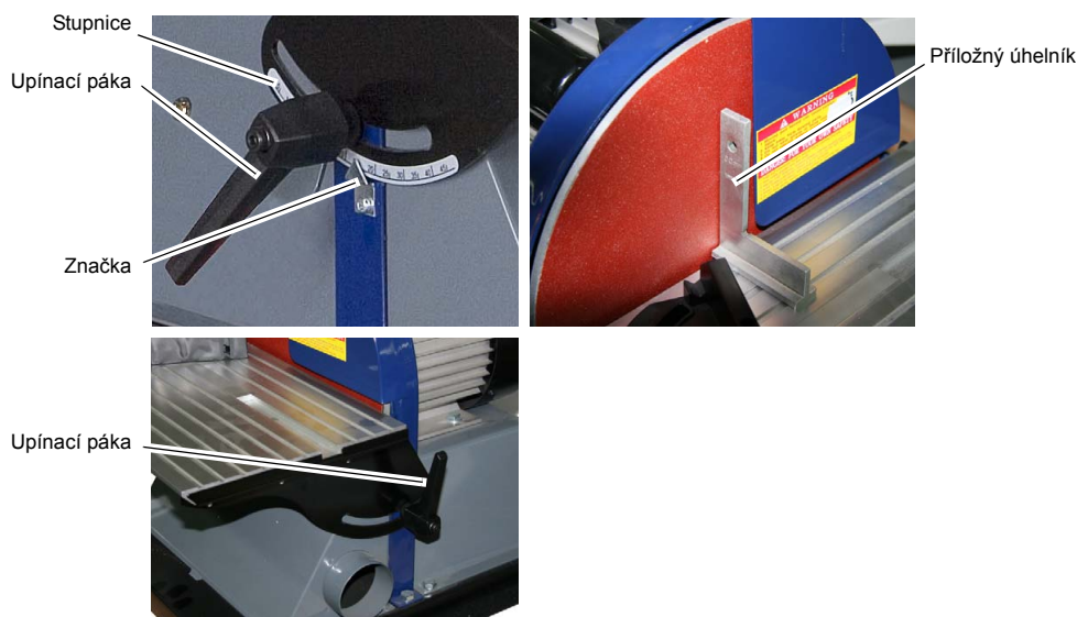
Obr.4-1: Nastavení sklonu
