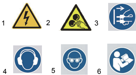
Obr. 2: Výstražné štítky - 1 Nebezpečné elektrické napětí | 2 Varování před rotujícími částmi stroje 3 Vytáhněte síťovou zástrčku! | 4 Použijte ochranná sluchátka! | 5 Použijte ochranné brýle! | 6 Přečtěte si návod k obsluze
