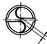
Querschneidenlänge 10 % vom Bohrer – \phi
