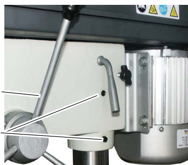
Obr. 3-7: Montáž vrtací hlavy
