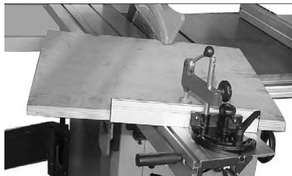
Obr. 42: Řez pod úhlem s úhlovým dorazem
