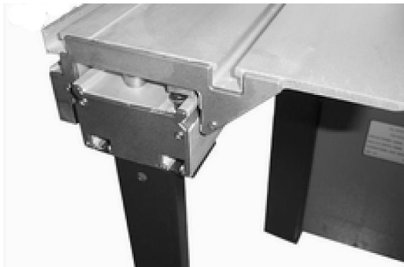
Obr. 16: Montáž posuvného suportu
