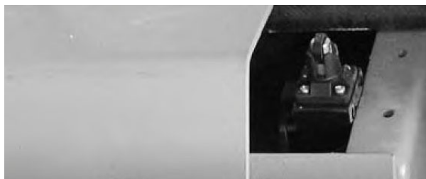
Obr. 3: Mikrospínač ochranného krytu
