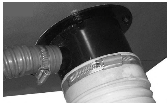
Obr. 27: Montáž odsávacích hadic
