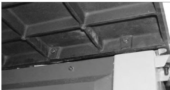
Obr. 10: Montáž litinového prodloužení stolu
