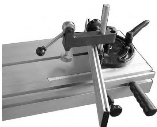
Obr. 40: Stupnice pro řezy pod úhlem na úhlovém dorazu
