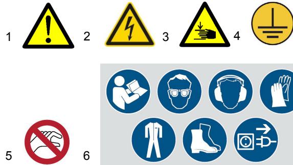
Obr. 1: Výstražné štítky : 1 Varování před nebezpečím | 2 Varování před nebezpečným elektrickým napětím | 3 Nebezpečí skřípnutí horních končetin | 4 Uzemnění | 5 Nedotýkejte se! | 6 Bezpečnostní pokyny
