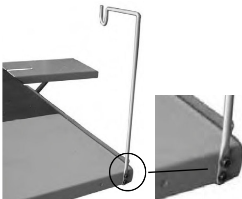
Obr. 25: Montáž vedení hadic
