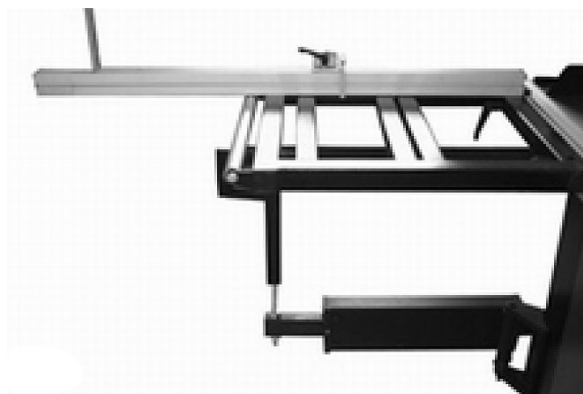
Obr. 33: Nastavení polohové páky
