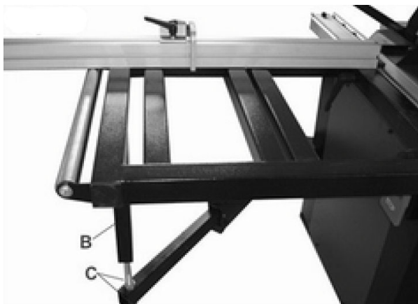
Obr. 20: Montáž posuvného stolu
