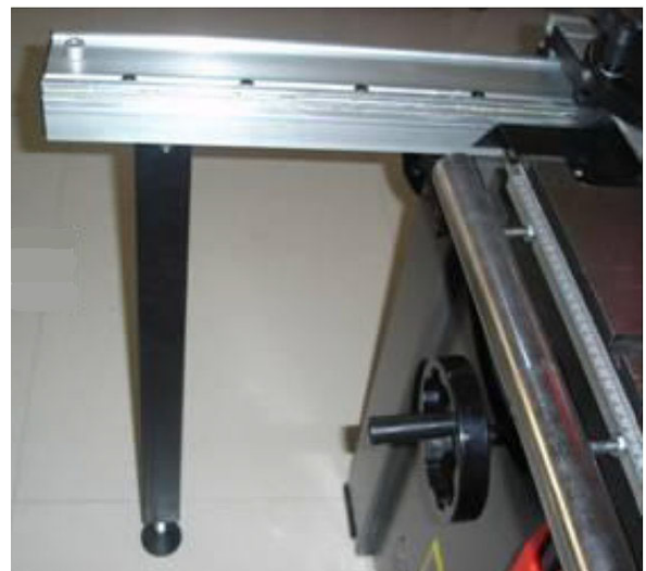
Obr. 18: Montáž podpěrné nohy
