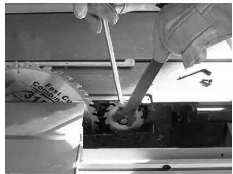
Obr. 46: Demontáž pomocného pilového kotouče
