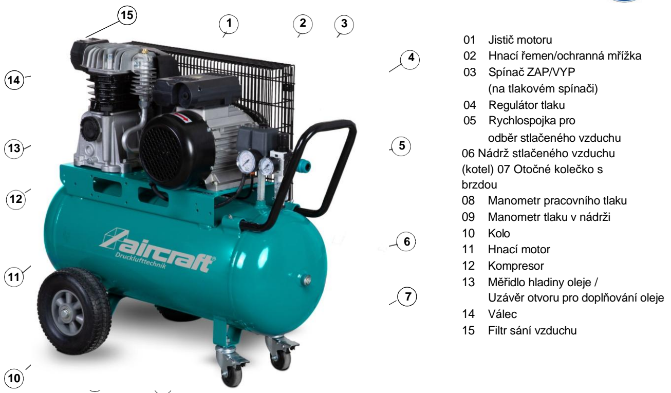
Obr. 5-1: Popis zařízení AIRSTAR 421/50
