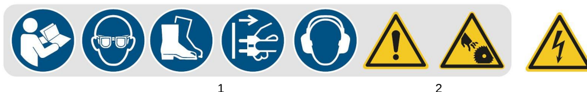
Obr. 1-1: Bezpečnostní značení – 1 Příkazové značky: Dodržujte návod k použití, používejte ochranu očí, používejte ochranu nohou, odpojte síťový kabel, používejte ochranu sluchu | 2 Výstražné značky: obecná výstražná značka, výstraha před elektrickým napětím
