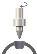
Beztržiskové vytvoření otvoru třecím teplem
